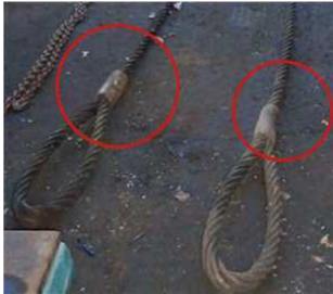
Spec tags missing
