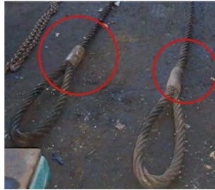
Spec tags missing
